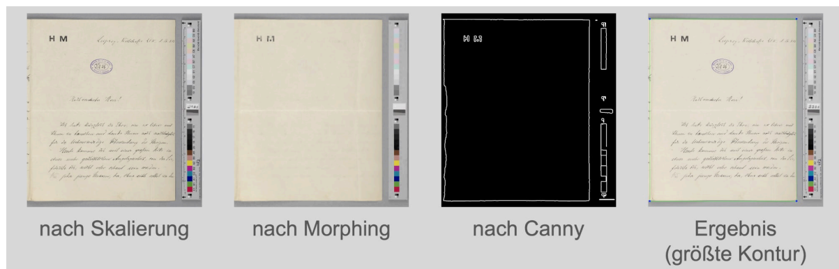
Abb. 2: Prozess der Document Detection mittels Gaussian Blur und Canny Edge Detection, dargestellt an einem Brief Heinz Möllers an Richard Dehmel. [Grafik: Nantke et al. 2026; Fotografie aus: Nantke (Hg.) 2022]
